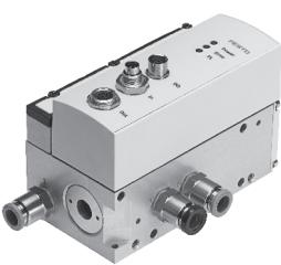
La válvula posicionadora de 5/3 vías para aplicaciones con Soft Stop y tareas de posicionamiento neumático. Plenamente digitalizada: con sensores de presión integrados, con nuevas funciones de diagnóstico. Disponible en tamaños 4, 6 y 8. Caudales de 350, 700 y 1 400 l/min.
