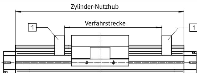
1 Festanschläge, auf dem Antrieb montiert oder extern
