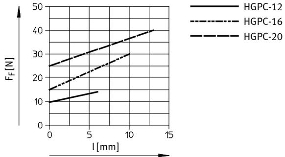
Zur Ermittlung der tatsächlichen Federkraft  $F_{Fges}$  muss der Hebelarm  $x$  berücksichtigt werden. In der nebenstehenden Tabelle stehen die Formeln zur Berechnung der Federkraft.
