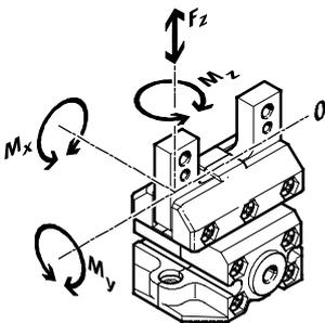
Die angegebenen zulässigen Kräfte und Momente beziehen sich auf einen Greifbacken. Die angegebenen Werte beinhalten den Hebelarm, zusätzliche Gewichtskräfte durch das Werkstück bzw. durch externe Greiffinger
