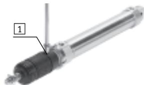
Der Faltenbalgbausatz ist ein leakage-freies System. Um das Ansaugen von unerwünschten Medien zu vermeiden, ist die Zu- bzw. Abluft des Bausatzes über eine Druckausgleichsöffnung im Anbindungsteil **1** gefasst. Der Bausatz schützt die Kolben-
