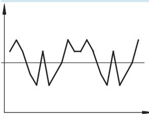
La precisión de repetición se refiere al margen de la magnitud de salida del fluido, aplicando repetidamente la misma señal eléctrica de entrada, proveniente de la misma dirección. La precisión de repetición se expresa en % de la señal de salida máxima del fluido.
