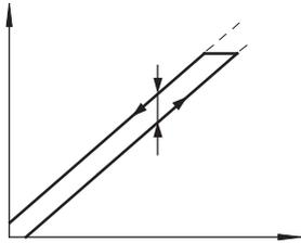
Entre el valor nominal y la presión obtenida siempre existe una relación lineal, dentro de un cierto margen de tolerancia. Sin embargo, hay una diferencia según aumenta o disminuye el valor nominal. La diferencia de la desviación máxima se llama histéresis.
