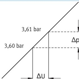
La precisión posible para modificar (regular) la presión depende de la sensibilidad de reacción de la unidad. La diferencia del valor nominal más pequeña, capaz de provocar el cambio de la presión de salida, se llama sensibilidad de reacción. En este caso, esa diferencia es de 0,01 bar.
