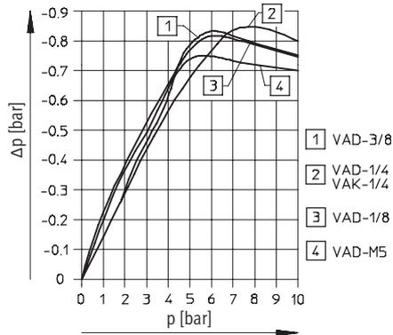
Capacidad de aspiración  $q_n$  en función del vacío  $p$
