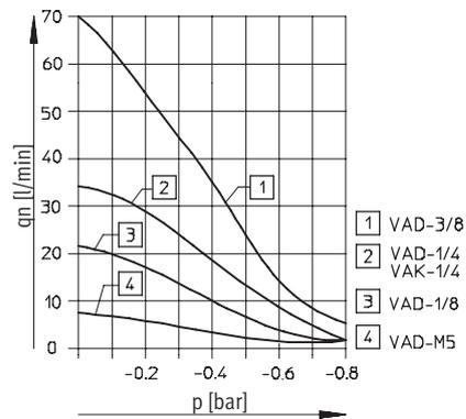
Capacidad de aspiración  $q_n$  en función de la presión de funcionamiento  $p$
