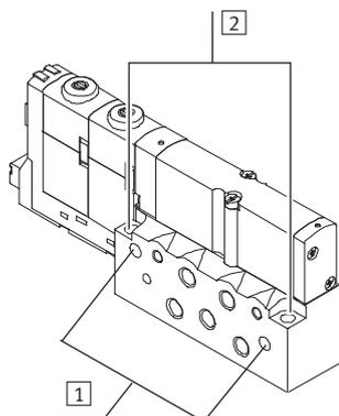
Zur Integration in eine Anlage bzw. Maschine ist der Einzelplatz-Basisblock für die Wandmontage vorgesehen.
