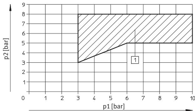
1) Arbeitsbereich für Ventile mit externer Steuerluftversorgung
