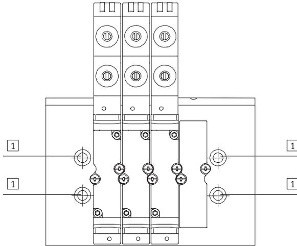
Die CPA-SC Ventilinsel wird mittels vier M4-Schrauben auf der Befestigungsfläche angeschraubt.
