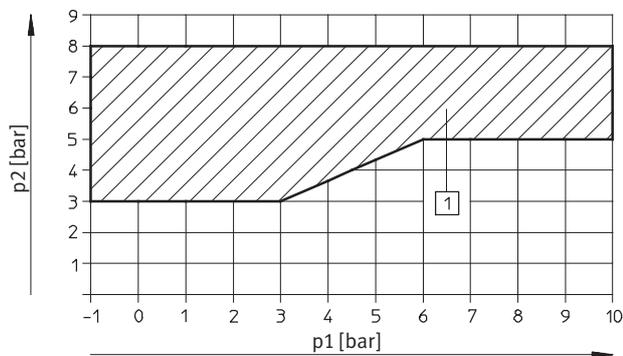
1) Arbeitsbereich für Ventile mit externer Steuerluftversorgung
