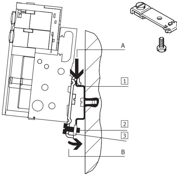
Die CPA-SC Ventilinsel wird in die Hutschiene eingehängt (siehe Pfeil A). Danach wird die CPA-SC Ventilinsel auf die Hutschiene geschwenkt und durch das Klemmstück befestigt (siehe Pfeil B).
