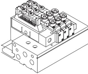
Bei dieser elektrischen Anschlussvariante werden alle Ventile zentral über den 26-poligen Anschlussstecker angesteuert. Der elektrische Anschluss befindet sich auf der linken Seite und lässt sich um 90° schwenken.
