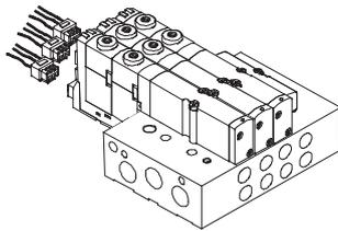
Die Ventilinsel ist mit 2 bis max. 16 Ventilplätzen konfigurierbar. Mit dieser elektrischen Anschlussart können max. 32 Magnetspulen angesteuert werden. Bei einem Wechsel eines Ventils muss der Horizontal-Connector (HC) vom Ventil gelöst werden.
