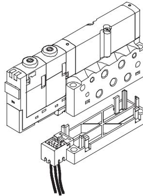
Bei dieser elektrischen Anschlussvariante wird der Anschlussstecker an einen Adapter montiert. Dieser wird dann am Basisblock befestigt.
