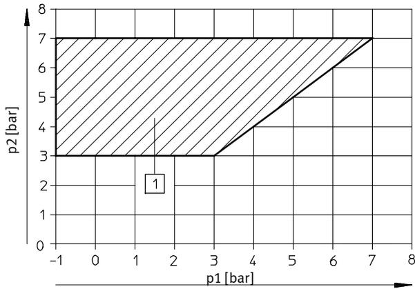
1 Arbeitsbereich für Ventile mit Steuerluftversorgung, extern
