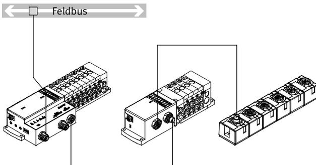
Die optionale Strangerweiterung bietet die Möglichkeit, weitere Ventilinseln und E/A-Module an den Feldbusknoten der CPV-SC anzuschließen. Ein CP-Strang des Installationssystems CPI ist als Erweiterung in den Feldbusknoten integriert. Es können verschiedene Ein- und Ausgangsmodule und CPV-, MPA-, CPV-SC-, CPA-Ventilinseln angeschlossen werden.
