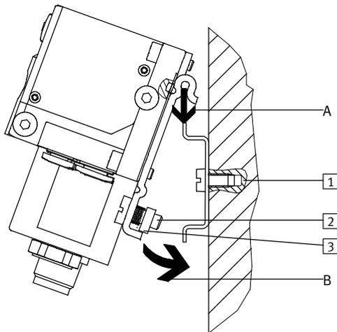
Die CPV-SC Ventilinsel wird in die Hutschiene eingehängt (siehe Pfeil A).
