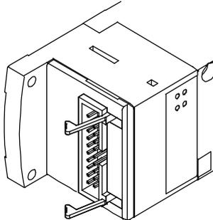
Bei dieser elektrischen Anschlussvariante werden alle Ventile zentral über den 20-poligen Anschlussstecker angesteuert. Der elektrische Anschluss befindet sich auf der linken Seite.
