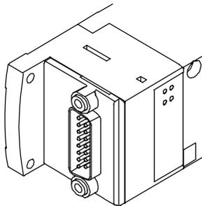
Bei dieser elektrischen Anschlussvariante werden alle Ventile zentral über den 15- und 26-poligen Anschlussstecker angesteuert. Der elektrische Anschluss befindet sich auf der linken Seite.
