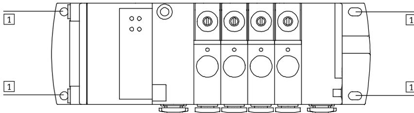
1 Montagebohrungen für Schrauben M3
