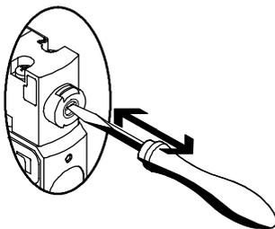
HHB wird durch Drücken mit Stift oder Schraubendreher betätigt und über Federkraft zurückgestellt.
