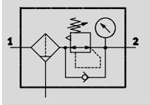
Kondensatablass halb- oder vollautomatisch, mit Manometer
