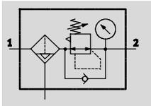
In diesem Gerät sind Filter und Druckregelventil zu einer Einheit zusammengefasst. Der Sinterfilter mit Wasserabscheider befreit die Druckluft von Schmutz, Rohrsinter, Rost und Kondenswasser.
