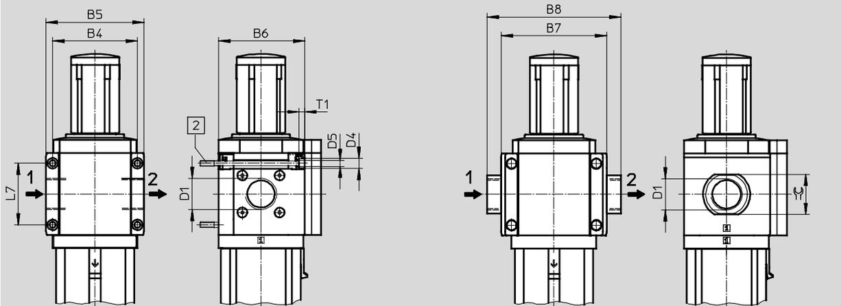
2 Befestigungsschraube M6xmin.90 nach DIN 912 (nicht im Lieferumfang enthalten) zur Wandmontage ohne Befestigungswinkel
