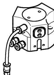
Bei Einsatz des Greifers in feuchter Umgebung oder unter Verwendung von flüssigen / gasförmigen Medien ist darauf zu achten, dass der Filter in eine neutrale Umgebung gelegt wird. Dasselbe gilt für nicht benötigten Druckluftanschlüsse, bei Einsatz als einwirkender Greifer.
