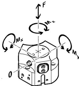
Die angegebenen zulässigen Kräfte und Momente beziehen sich auf einen Greifbacken. Sie beinhalten den Hebelarm, zusätzliche Gewichtskräfte durch das Werkstück bzw. durch externe Greiffinger und auftre-
