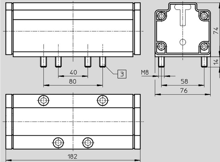
3 Viti di fissaggio antisifilamento
