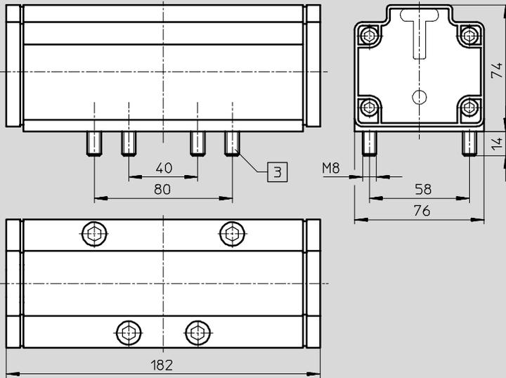
3 Viti di fissaggio antisfilamento
