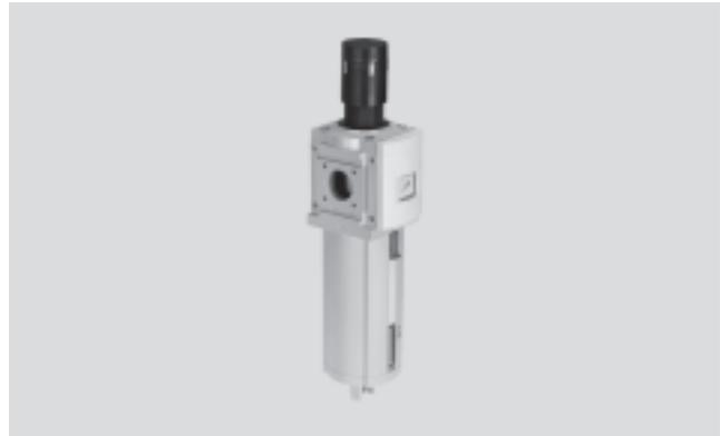
Este equipo está constituido por un filtro y una válvula reguladora de presión que forman una unidad. El filtro sinterizado con separador de agua retiene partículas de suciedad, depósitos minerales de los tubos, óxido y condensados.
