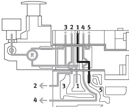
Der reversible A-Regler splittet die Arbeitsluft im Kanal 1 auf und regelt den Druck vor dem Ventil in den Kanal 5 (im Kanal 3 steht der unregulierte Druck aus Kanal 1 an). Danach wird die geregelte Luft auf den Kanal 4 geregelt. Das Ventil wird dadurch reversibel betrieben.
