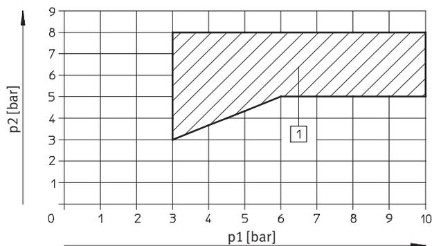
1) Arbeitsbereich für Ventile mit Steuerluftversorgung extern
