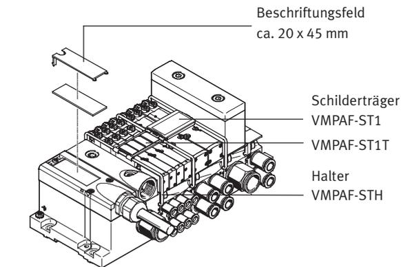
Zur Beschriftung der Ventile kann an jedem Anschlussblock ein Schilderträger VMPAF-ST1 (Teile-Nr. 546 228, Code T im Bestellcode, mit Papierschild bestückbar) oder VMPAF-ST1T (Teile-Nr. 544 422, mit Bezeichnungsschildern IBS-9x20 bestückbar) montiert werden. Alternativ oder ergänzend dazu können großflächige Bezeich-
