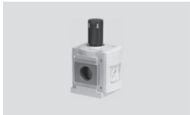
Das Druckregelventil hält den Ausgangsdruck p2, unabhängig von Druckschwankungen im Netz und vom Luftverbrauch, weitgehend konstant. Der Ausgangsdruck p2 ist innerhalb des Druckregelbereichs entweder manuell mit dem Drehknopf, pneumatisch über einen Steuerdruck
