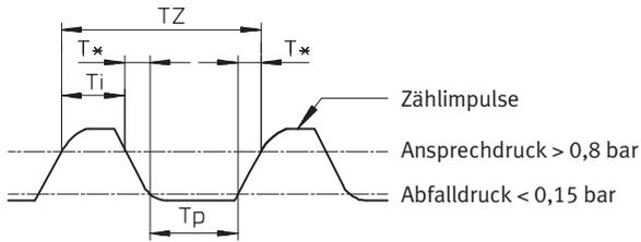
$$\text{Maximale Impuls geschwindigkeit} = \frac{1}{T_Z}$$
