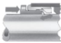
Über die rostfreie Stahlkralle wird der Schlauch ohne Beschädigung der Oberfläche gehalten. Schwingungen und Druckstöße werden absorbiert. Das Lösen des Schlauches erfolgt durch einfaches Niederdrücken des blauen Lösungsringes. Der Schlauch Außendurchmesser ist zur besseren Zuordnung auf dem Lösering angegeben.
