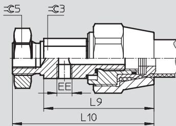
ER/BR-EG/BG – pneumatischer Anschluss radial mit Gewindestange, einseitig/beidseitig
