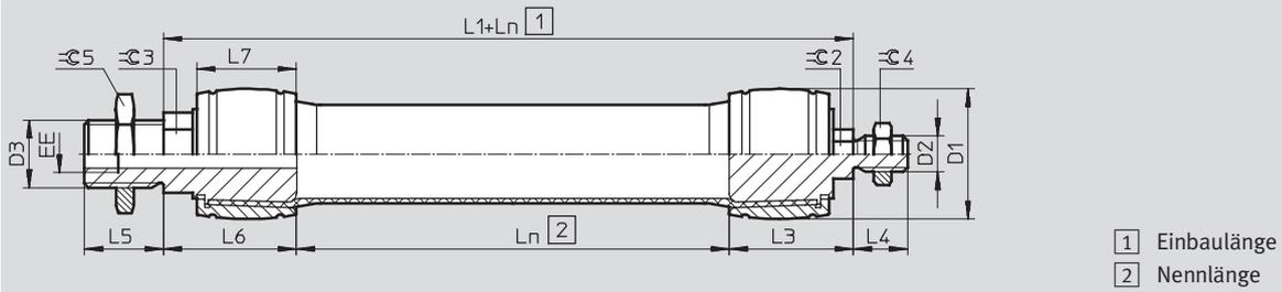
AM-AM – pneumatischer Anschluss axial, beidseitig
