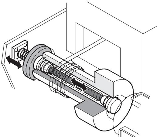
Mit dem reibungsfreien Muskel ist ein gleichmäßiges und sanftes Bremsen der Abwickeltrommel möglich. So kann bei konstanter Geschwindigkeit das Aufwickeln höchst präzise verlaufen. Die Ansteuerung erfolgt über ein Proportionalventil, dessen Signale über Kraftsensoren geregelt werden.
