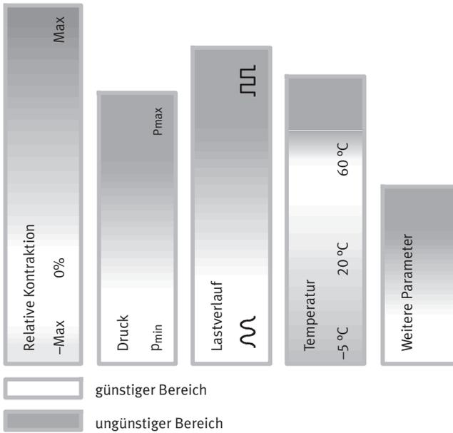
Die Lebensdauer des Pneumatischen Muskels liegt für typische Anwendungen zwischen 100 000 und 10 Mio. Schaltzyklen. Mit den Hinweisen aus dem Diagramm links, können gegebenenfalls Optimierungen vorgenommen werden. So steigt z. B. die Lebensdauer durch eine Verringerung der
