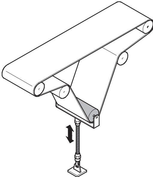
In staubiger oder verschmutzter Umgebung ist ein hermetisch dichter Pneumatischer Muskel gegenüber herkömmlichen Antrieben deutlich im Vorteil. Keine Dichtung, die verschleifen kann. Nur ein robuster Konstruktions-schlauch, der z. B. auch den harten Einsatz in der Zement-Industrie mit Leichtigkeit bewältigt.
