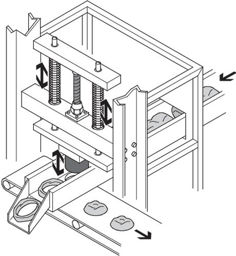
Mit dem Muskel sind sehr hohe Taktraten möglich. Einerseits aufgrund seines leichten Gewichts. Andererseits, weil er ohne bewegte Teile wie z. B. einem Kolben auskommt. Der einfache Aufbau – ein Muskel über zwei Federn vorgespannt – ersetzt ein kompliziertes Kniehebel-Spannsystem mit Zylindern. So ist eine Frequenzsteigerung von 3 auf 5 Hz möglich. Über 10 Millionen Lastwechsel können so erzielt werden.
