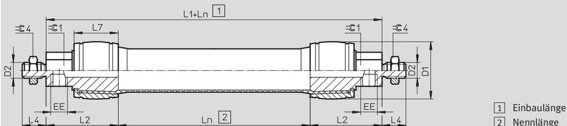
AM-RM – pneumatischer Anschluss axial und radial
