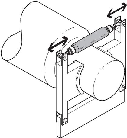
In Einsatzbereichen, die schnelle Reaktionen erfordern, setzt der Pneumatische Muskel neue Maßstäbe. Bei der Notstoppeinrichtung für Walzen wird neben der Schnelligkeit auch Kraft gefordert. Somit können längere Maschinenausfallzeiten bei Störfällen verhindert werden.
