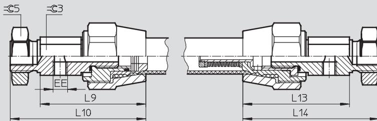
EA/BA-EG/BG – pneumatischer Anschluss radial mit Gewindestange, einseitig/beidseitig
