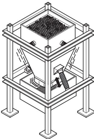
In Vorratsspeichern oder Silos treten beim Zuführen immer wieder Probleme mit verklemmten Förderteilen auf. Mit Hilfe des Muskels kann ein pneumatischer Klopfer stufenlos zwischen 10 und 90 Hz geregelt werden. So ist ein kontinuierlicher Förderprozess garantiert.
