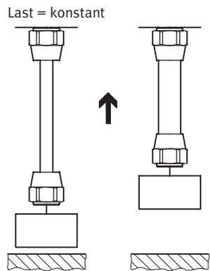
Der Muskel verhält sich bei Änderung einer äußeren Kraft wie eine Feder: Er folgt der Krafteinwirkung. Beim Muskel kann sowohl die Vorspannkraft dieser „pneumatischen Feder“ als auch ihre Federsteifigkeit beeinflusst werden. Der Muskel kann in seiner
