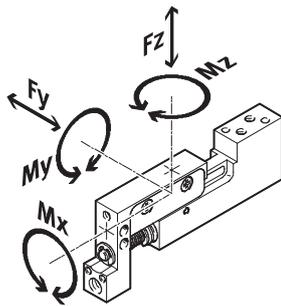
Wirken gleichzeitig mehrere der unten genannten Kräfte und Momente auf den Antrieb, muss neben den aufgeführten Maximalbelastungen folgende Gleichung erfüllt werden:
