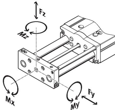
Wirken gleichzeitig mehrere der unten genannten Kräfte und Momente auf den Antrieb, müssen neben den aufgeführten Maximalbelastungen folgende Gleichung erfüllt werden:
