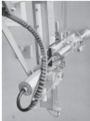
Ein strahlendes Umfeld von bis zu 4 Sievert/h und der Einsatz unter voll-entsalztem Wasser in einem Manipulator zur Zerlegung von Kernreaktor-Druckbehältern und thermischen Schildern.
