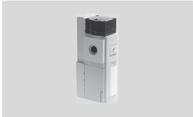
Le distributeur de mise en circuit et d'échappement électromécanique offre une mise hors pression sûre et une mise en pression en douceur dans les systèmes de conduites pneumatiques et dans les terminaux industriels. Pour l'appareil, il s'agit d'un système mécatronique d'autocontrôle
