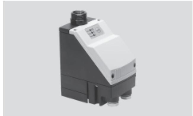
El condensado llega a la válvula de purga a través del taladro que se encuentra en el fondo del vaso del filtro. Finalmente, se acumula en un recipiente. Mediante un detector capacitivo se controla el nivel del condensado en el recipiente. Una vez que se alcanza el nivel máximo, se abre una válvula de membrana y el condensado
