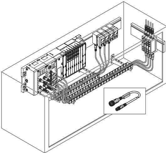
Las aplicaciones básicas se caracterizan por el tendido fijo de los cables sin exposición a esfuerzos mecánicos.
