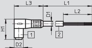
1 Conector acodado tipo zócalo      2 Cable de PUR
