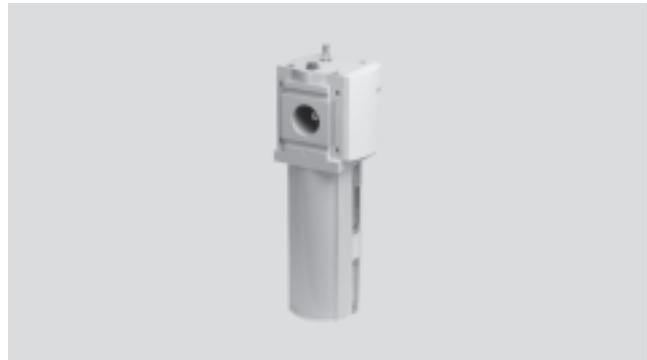
El lubricador proporcional dosifica una fina cantidad de aceite, mezclándolo con el aire a presión. La caída de presión que se produce al pasar el aire por una tobera Venturi sirve para elevar el aceite desde el
