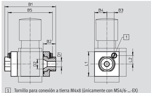
1) Tornillo para conexión a tierra M4x8 (únicamente con MS4/6-...-EX)
