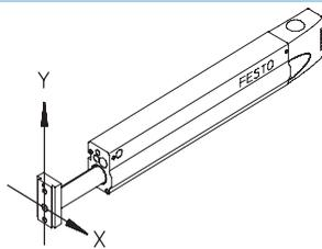
Si el centro de gravedad de la masa fijada a la placa frontal se encuentra dentro de la superficie básica de dicha placa, queda excluida una sobrecarga del módulo lineal.
