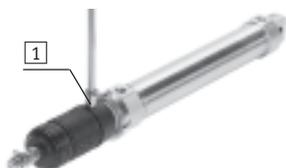
El fuelle no tiene fugas. Con el fin de evitar la aspiración de fluidos no apropiados, la pieza de conexión **1** tiene un taladro para alimentación y descarga común del aire. Esta solución protege el vástago, la junta y la culata frente a fluidos
