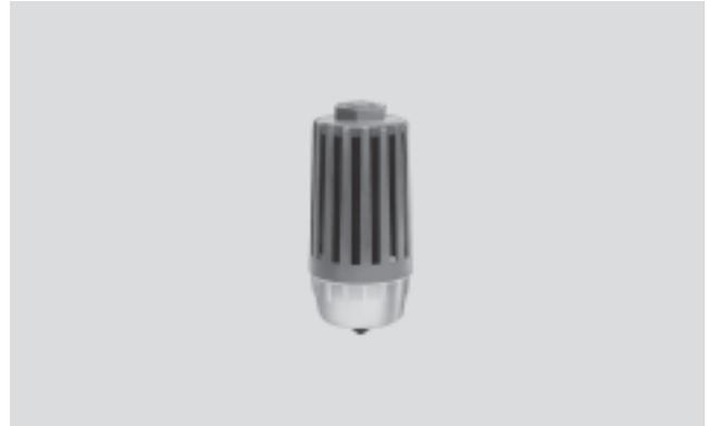
Mit dem Filter-Schalldämpfer wird die gesammelte Abluft von pneumatischen Steuerungen gereinigt. Die Abluft entweicht dabei über einen Feinfiltereinsatz (Abscheidegrad >99,99%) in die Atmosphäre.
