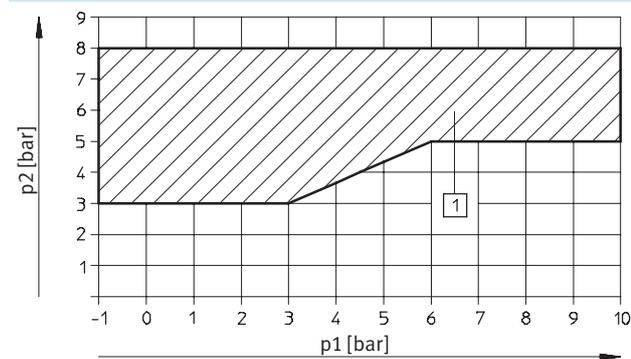
1) Arbeitsbereich für Ventile mit externer Steuerluftversorgung
