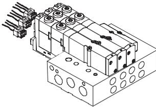
Die Ventilinsel ist mit 2 bis max. 16 Ventilplätzen konfigurierbar. Mit dieser elektrischen Anschlussart können max. 32 Magnetspulen angesteuert werden. Bei einem Wechsel eines Ventils muss der Horizontal-Connector (HC) vom Ventil gelöst werden.
