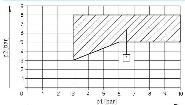
1) Arbeitsbereich für Ventile mit externer Steuerluftversorgung
