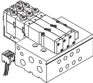
Die Ventilinsel ist mit 2 bis max. 16 Ventilplätzen konfigurierbar. Mit dieser elektrischen Anschlussart können max. 32 Magnetspulen angesteuert werden. Die Anschlussstecker werden in die Nut des Anschlussblocks eingeschoben. Ein Ventilwechsel oder eine Erweiterung (Reserveplatz) erfordert nur das Lösen von zwei Schrauben, die Anschlussstecker verbleiben in der Nut.
