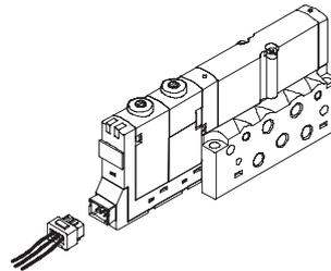
Beim Einzelplatz-Basisblock ist der elektrische Anschluss direkt am Ventil einsteckbar.
