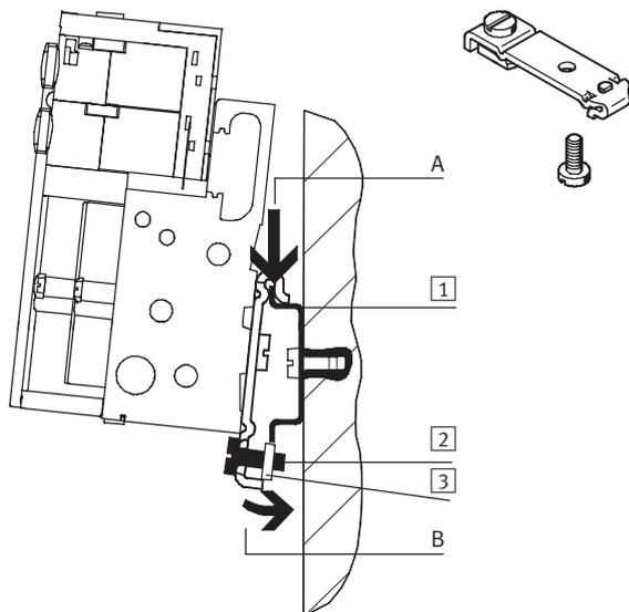
Die CPA-SC Ventilinsel wird in die Hutschiene eingehängt (siehe Pfeil A). Danach wird die CPA-SC Ventilinsel auf die Hutschiene geschwenkt und durch das Klemmstück befestigt (siehe Pfeil B).
