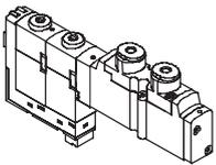
Halbmuffenventile ermöglichen den pneumatischen Anschluss nach oben. In diesem Fall kann auf Winkelverschraubungen verzichtet werden.
