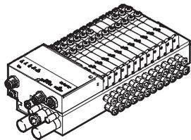
Die Kommunikationsverbindung zu einer übergeordneten SPS übernimmt ein integrierter Feldbusknoten. Somit läßt sich eine kleinbauende Lösung in Pneumatik und Elektronik realisieren. Der Feldbusknoten ist dabei direkt in die elektrische Ansteuerung der Ventilinsel integriert
