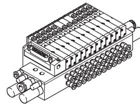
Die Signalansteuerung von der Steuerung zur Ventilinsel erfolgt über ein mehradriges vorkonfektioniertes Kabel; dadurch wird der Installationsaufwand erheblich reduziert.
