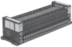
Ventilinsel mit Einzelanschluss: Unabhängig von der Steuerung und flexibel anschließbar mit vorkonfektionierten Kabeln. Dadurch wird ein verpolungssicherer Anschluss gewährleistet. Im Anschlussstecker befindet sich eine LED für die Schaltzustandsanzeige und Schutzbeschaltung gegen Überspannung.
