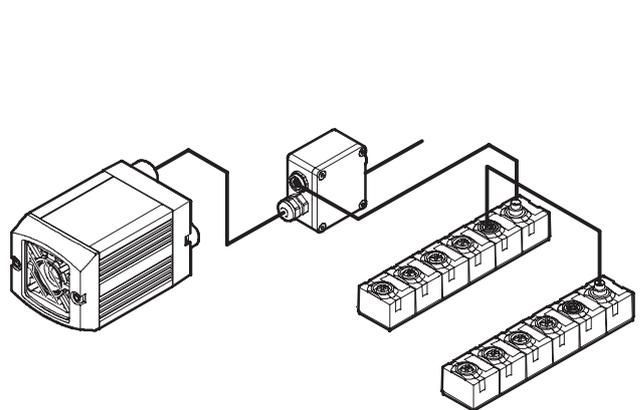
Über die CAN-Schnittstelle der Kamera können ein Eingangs- und ein Ausgangsmodul mit der Kamera verbunden werden.
