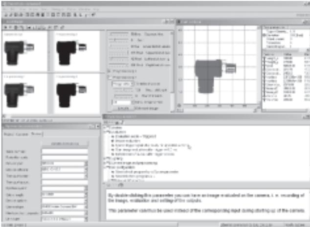
Mit der Software CheckKon lassen sich sämtliche Vorgänge innerhalb der Kamera von der Bildaufnahme bis zu den Ein- und Ausgabeparametern anzeigen, protokollieren und anpassen.
