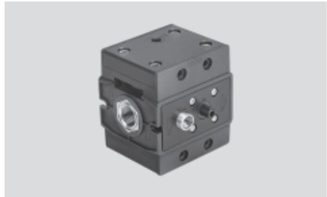
Pneumatisch betätigtes Einschaltventil für langsamen Druckaufbau in pneumatischen Anlagen. Damit wird der Anlauf von pneumatischen Anlagen abgesichert. Über ein einstellbares Drosselventil strömt eine geringe Luftmenge in die Anlage. Der Ausgangsdruck wird langsam aufge-
