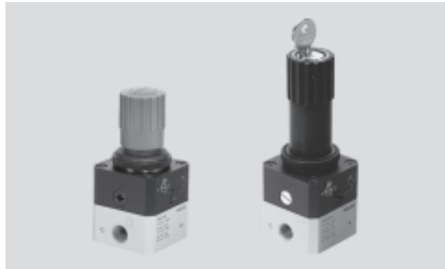
Das Präzisions-Druckregelventil regelt den Arbeitsdruck (Sekundär-Seite) über eine Membransteuern, die auf den Hauptsitz einwirkt und dadurch eine bessere Regelcharakteristik erreicht.
