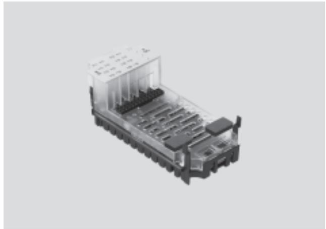
Das Multi-E/A-Modul dient zur Ansteuerung von Geräten mit einer hohen Anzahl von Ein- und Ausgängen pro Anschlusspunkt. Durch die Unterstützung der Sub-D Anschlussblöcke lassen sich installationssparend Bedientafeln mit Tastern und Lampen an das CPX-Terminal anschließen.
