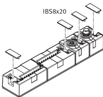
Die kompakten CP-Module besitzen für jeden Anschluss jeweils eine Aufnahme für ein Bezeichnungsschild IBS8x20 (Teile-Nr. 539 388).
