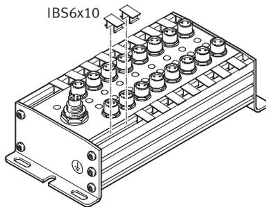
Die robusten CP-Module verfügen über zwei Nuten, in die Bezeichnungsschilder IBS6x10 (Teile-Nr. 18 576) montiert werden können. Für jeden Anschluss kann mindestens ein Bezeichnungsschild montiert werden.
