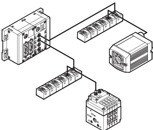
Das Kompaktkammersystem SBOx-Q kann in ein Festo CPI-Netzwerk integriert werden. Dabei verhält es sich wie ein binäres Modul mit je 16 Ein- und Ausgängen.
