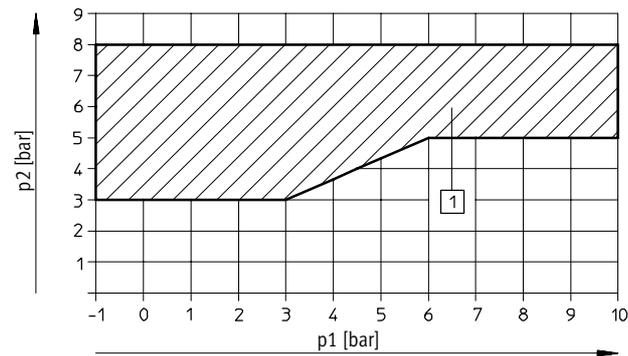
1 Margen de funcionamiento de válvulas con aire de pilotaje externo
