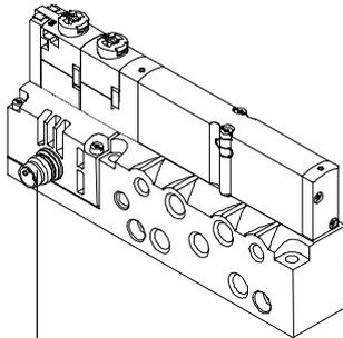
Conector tipo clavija M8 x 1,
