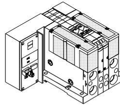
Terminal de válvulas AS-Interface con alimentación adicional
