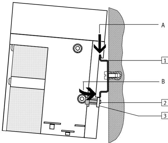
El terminal de válvulas CPA se cuelga en el perfil DIN (ver flecha A). A continuación se gira el terminal y se fija mediante la pieza de bloqueo.
