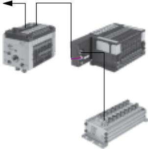
CPV Direct es un sistema compacto para la conexión de un terminal de válvulas CPV a 9 estándares de bus de campo. Ello significa que es posible la conexión a los buses de campo más importantes, tales como Profibus, Interbus, DeviceNet y CANopen. El nodo de bus de campo está integrado en la línea de accionamiento eléctrico del terminal CPV, por lo que ocupa muy poco espacio.
