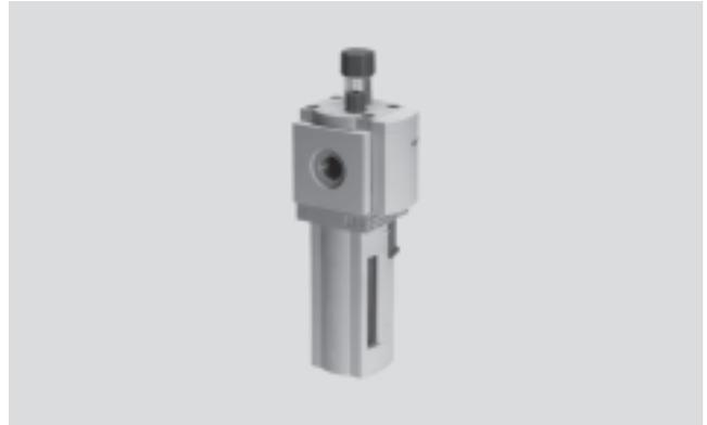
El lubricador proporcional dosifica una fina cantidad de aceite, mezclándolo con el aire a presión. La caída de presión que se produce al pasar el aire por una tobera Venturi sirve para elevar el aceite desde el depósito hasta la campana de goteo. Desde allí las gotas de aceite fluyen al aire, donde se nebulizan. La cantidad de aceite nebulizado es proporcional
