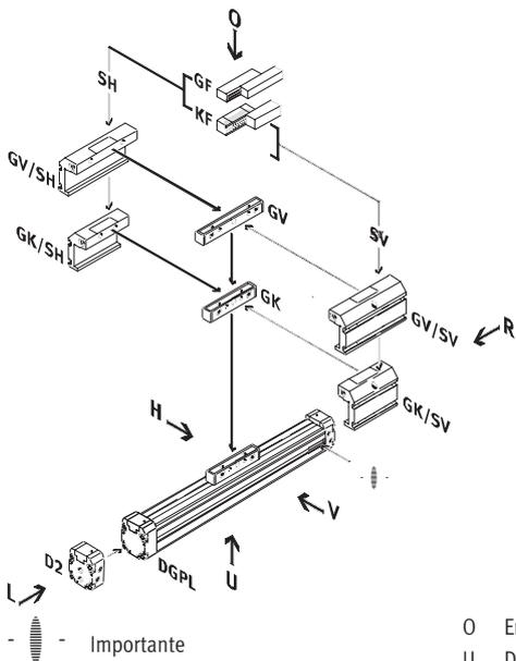
El taladro de entrada para detectores de proximidad se encuentra en el lado derecho del actuador lineal neumático DGPL.
