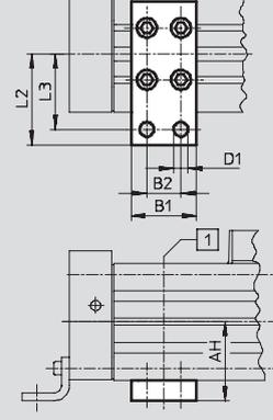
1 Posición indistinta del soporte central en la zona del tubo perfilado.
