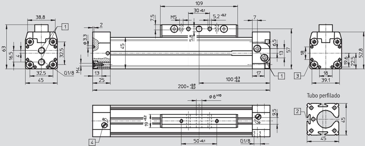
1 Toma de aire comprimido en un lado; conexión a elegir en 3 lados de una culata posterior (variante D2: toma de aire en dos lados; conexión a elegir en 3 lados en cada culata)
