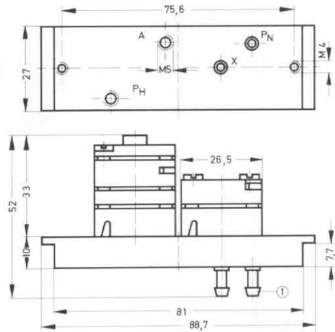
① Stecknippel für Kunststoffschlauch NW 4
