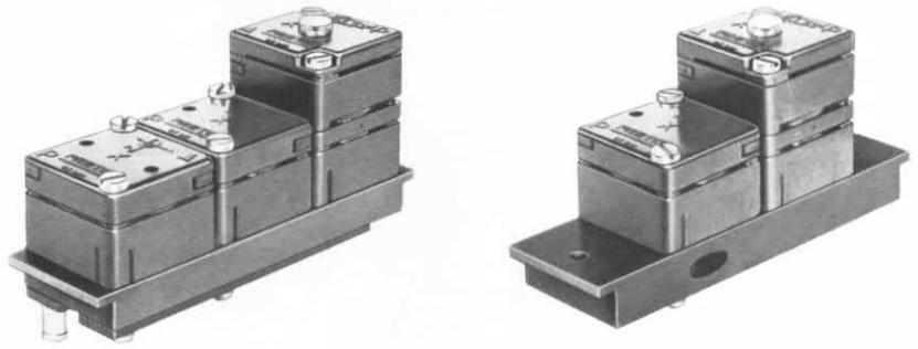
Diese Bausteine dienen der Verknüpfung und Verstärkung von Signalen mit einem Druck von 0,001 bis 0,25 bar, welche als Ausgangssignale von pneumatischen Sensoren zur Verfügung stehen.
