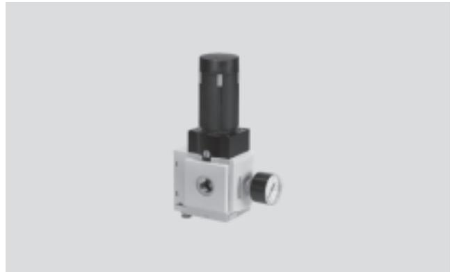
Das Präzisions-Druckregelventil eignet sich für sensible Anwendungen mit einer geforderten Druckhysterese von 0,02 bar. Das Druckregelventil ist geeignet für Batteriemontage mit durchgeführter Versorgungsluft, zum Aufbau einer Reglerbatterie mit voneinander unabhängigen Druckregelbereichen. Der Druckausgang ist vorn oder hinten.
