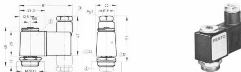
Hinweis: Bei Montage auf Magnetventile mit Handhilfsbetätigung ist diese außer Funktion
