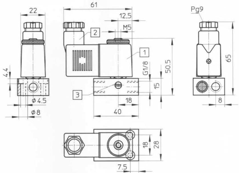
Zulässiges Anzugsdrehmoment der Befestigungsmutter für Magnetspule = 150 Ncm (15 kpcm)
