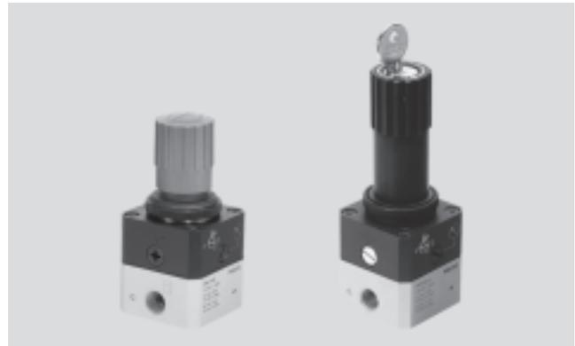
Das Präzisions-Druckregelventil regelt den Arbeitsdruck (Sekundär-Seite) über eine Membranvorsteuerung, die auf den Hauptsitz einwirkt und dadurch eine bessere Regelcharakteristik erreicht.
