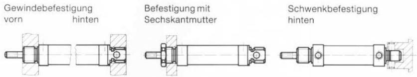
Einbauvarianten und zusätzliche Befestigungselemente
