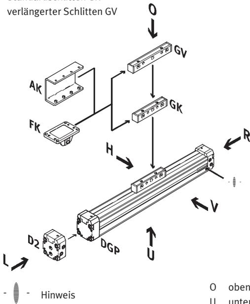
Die Einlassöffnung für Näherungsschalter befindet sich auf der rechten Seite des pneumatischen Linearantriebs DGP.
