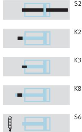
Die Variante S6 ist aufgrund der verwendeten Dichtungen und des verwendeten Fettes nicht für den direkten Kontakt mit Lebensmitteln geeignet.
