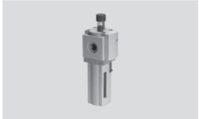
Der Proportional-Öler führt der Druckluft eine fein dosierbare Ölmenge zu. Das Druckgefälle, das beim Durchströmen einer Venturidüse entsteht, wird benützt, um aus einem Behälter Öl bis zur Abtropfkappe zu fördern. Von dort fließt der Öltropfen kurz hinter dem Proportionalventil in den Luftkanal, wo er zerstäubt wird. Der
