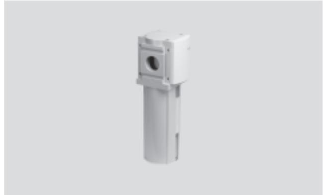
Der Sinterfilter mit Zentrifugalabscheidung befreit die Druckluft von Schmutz, Rost und Kondenswasser. Die Filterpatronen sind austauschbar.
