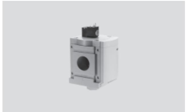
Die Dauer des Druckaufbaus wird über die am Ventildeckel angebrachte Drossel eingestellt. Entsprechend der eingestellten Drosselstellung steigt der Ausgangsdruck p2 langsam an. Solange das Magnetventil nicht betätigt wird, steht nur der Durchfluss der Drossel zur Verfügung. Erst durch Bestromen des Magnetventils wird der Hauptsitz geöffnet.
